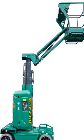
10,00 m Arbeitshöhe bis max. Plattformhöhe bis max. 8,00 m Seitliche Reichweite 3,00 m Traglast 200 kg Plattformgrösse 0,98 / 0,78 m Antrieb Batterie Ladegerät 230 V Länge / Breite / Höhe 2,70 / 1,00 / 1,99 m Eigengewicht 2677 kg Transportmöglichkeit auf LKW oder Tieflader
